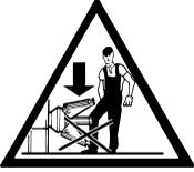
Bei Absenken des Spannsystems - sowohl bei Offenstehen desselben als auch bei aufmontiertem Rad -, stets einen Sicherheitsabstand einhalten, um Quetschungen zu vermeiden.
