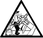
NIE zwischen Werkzeugaggregat und Felge oder Rad, wenn diese auf dem Spannsystem befestigt sind, treten.
