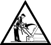
Bei Kippen des Werkzeugaggregats Sicherheitsabstand einhalten. Quetschgefahr!
