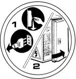
Vor Servicearbeiten an der Maschine Netzstecker aus der Steckdose ziehen.
