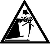
Radbolzen nie als Kraftpunkt zum Heben der Maschine verwenden.
