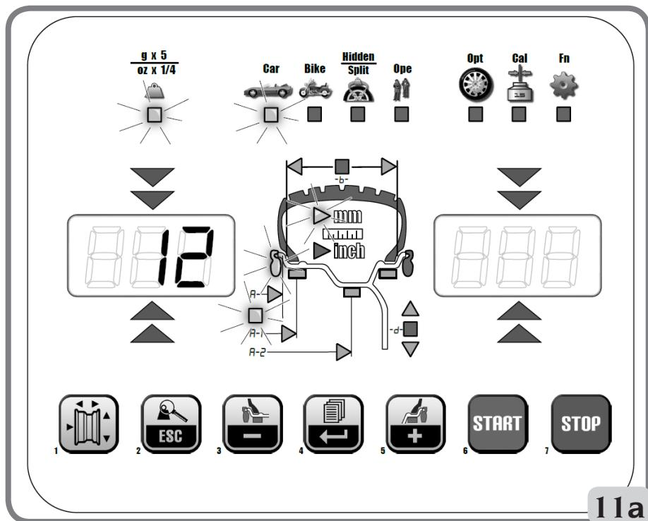
Cuando se memoriza la medida, en la pantalla izquierda permanece visualizado el valor de la distancia adquirida por la máquina:
