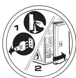
Vor Servicearbeiten an der Maschine immer erst den Stecker aus der Steckdose ziehen.
