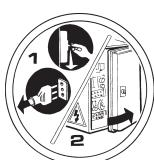
Débrancher la prise de l'alimentation avant d'effectuer des interventions d'entretien sur la machine.
