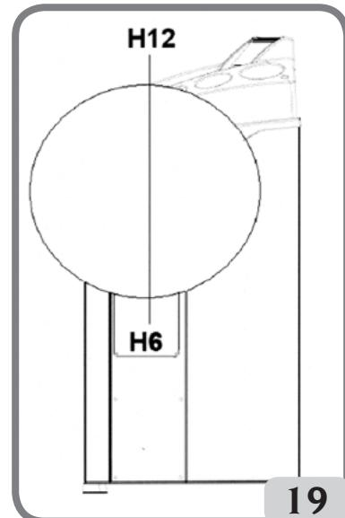
auf einem Display weiterhin der Unwuchtwert der auszuwuchtenden Seite angezeigt und auf dem anderen Display erscheint der Schriftzug "H.6", der die korrekte Anbringungsposition anzeigt, wie in Abb. 19 angegeben.
