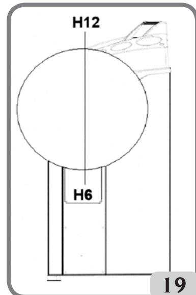
fase, en una pantalla permanece indicado el valor del desequilibrio del flanco que debe equilibrarse y, en la otra, aparece el mensaje "H.6" que indica la posición correcta de aplicación, como se indica en la figura 19.
