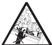
No utilizar el perno porta-rueda como asidero para levantar la máquina.
