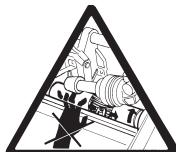
Für das Anheben der Maschine niemals die Radträgerwelle als Hebelelement verwenden.
