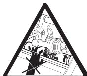
Pour tout levage de la machine ne pas utiliser l'axe du porte-roue comme point de prise.
