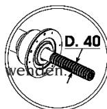
Bitte Zentrierungszubehör mit Bohrungsdurchmesser 40 mm verwenden.
