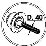
Utilizar accesorios de centrado con diámetro de 40 mm.
