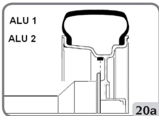
A la fin du lancement de contrôle, de légers balourds peuvent parfois se vérifier dus à la différence considérable de forme qui peut se présenter sur des jantes de dimensions nominales identiques. Modifier par conséquent le paramètre et l'emplacement des masses
