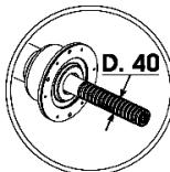
Utilizzare accessori centraggio con diametro foro 40 mm.
