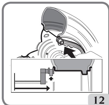
Prestar la máxima atención para colocar correctamente el brazo para obtener una lectura precisa de los datos.
