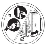
Desconectar la clavija de la toma de alimentación antes de efectuar intervenciones de asistencia en la máquina.
