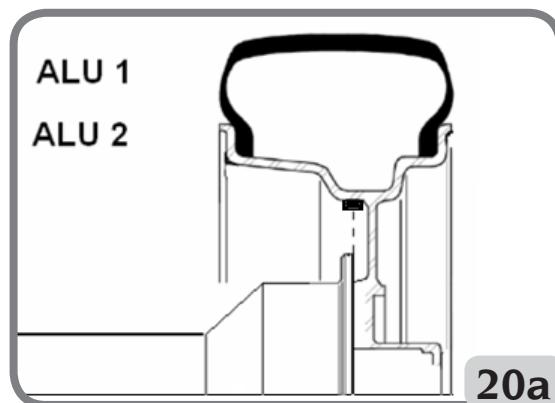
Nach dem Kontrollmesslauf kann eine geringe Restunwucht bestehen, die von den beachtlichen Formunterschieden der Felgen mit gleichen Nennmaßen abhängen. Daher den Wert und die Position der zuvor aufgrund der im Programm "POSITIONSAUSWAHL FÜR DIE ANBRINGUNG DER KLEBEWEICHTE" durchgeführten Konfiguration angebrachten Gewichte verändern, bis eine korrekte Auswuchtung erreicht ist.
