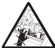
Pour tout levage de la machine ne pas utiliser l'axe du porte-roue comme point de prise.
