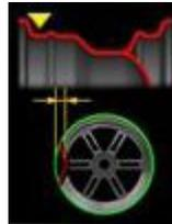
l'excentricité radiale de l'emplacement du talon intérieur du pneu (crête à crête) ;
