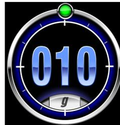
Jeder Anzeiger verfügt über eine Taste zur Änderung der Unwuchtmaßenheit von Gramm auf Unze oder umgekehrt.
