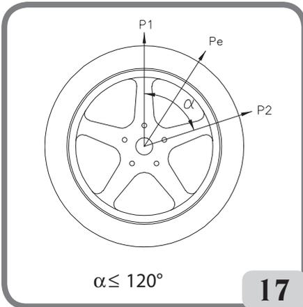
Die beiden Gewichte müssen sich innerhalb einem Winkel von 120 Grad befinden und das Gewicht Pe umfassen.
