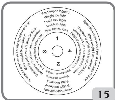
Es wird darauf hingewiesen, dass besonders bei großen Unwuchten ein Positionierungsfehler des Gegengewichts um wenige Grad in der Kontrollphase zu einem Restwert von 5 bis 10 Gramm führen kann.
