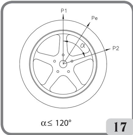
Les deux masses doivent se situer dans un angle de 120 degrés comprenant la masse Pe.
