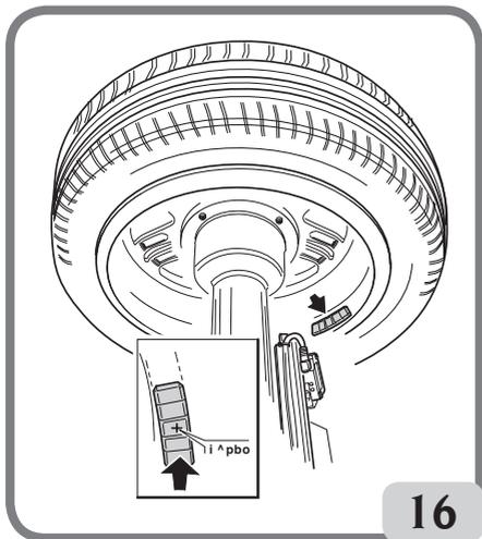
Damit das Gewicht dauerhaft auf der Felgenoberfläche haftet, muss diese vollkommen sauber sein. Die Oberfläche gegebenenfalls mit einem Reinigungsmittel säubern.
