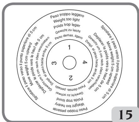
Il ne faut pas oublier que, surtout pour les balourds de grande importance, une erreur de positionnement du contrepoids de quelques degrés peut porter en phase de contrôle à un résidu de 5-10 grammes.
