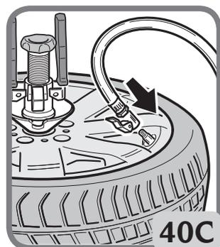
5. Appuyer par à-coups sur la pédale
