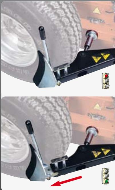
● Bead breaker shoe extension system useful for working on large-diameter wheels installed on the machine as standard ● *Serienmäßig mit verlängerbarer Abdrückschaufel für große Raddurchmesser*
