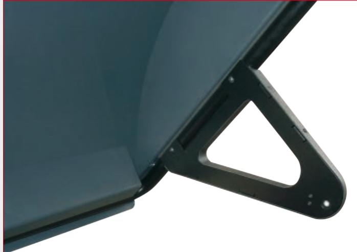
France **Détecteur AWD (Auto Width Device)** afin de mesurer automatiquement la largeur de la roue, sans entrer en contact avec le capteur (\*).
