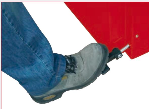
France **Frein de blocage de l'arbre porte-roue à pédale**, pour faciliter les opérations consistant à bloquer et débloquer la roue et appliquer les contrepoids (\*).
