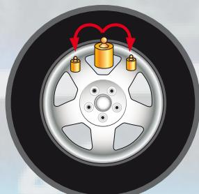
France Parfaite esthétique de la jante parce qu'elle permet de diviser la masse adhésive d'équilibrage du flanc externe en deux masses équivalentes placées en position cachée derrière les rayons.
