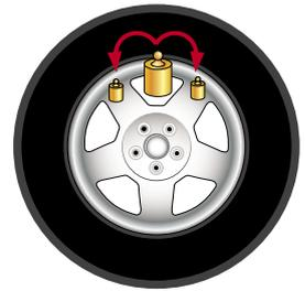
Programm Verstecktes Gewicht "**Hidden Weight**" (in Alu P) zur Unterteilung des Auswuchtklebegewichts der Außenseite in zwei gleichwertige, hinter den Speichen der Felgen positionierte Gewichte
