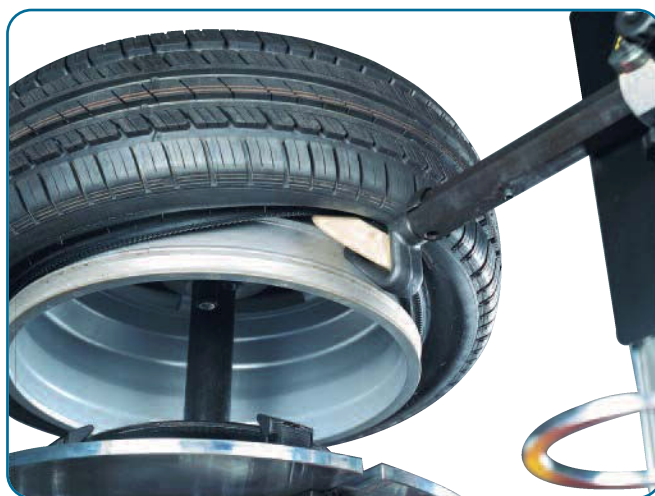
› Wulstabdrücken, Demontage des PAX-Reifens
