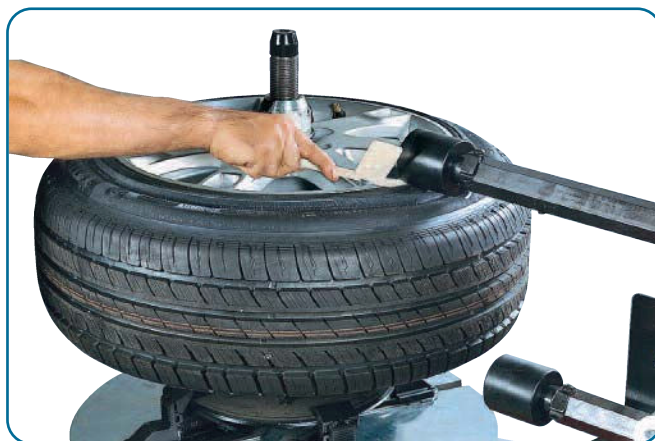
› Einsetzen des Felgenschutzes (reglette)
