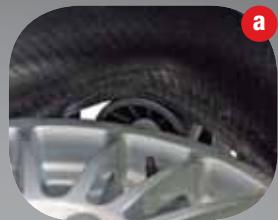
**2 IL DISCO GRANDE** consente il sollevamento del pneumatico e il distaccamento del tallone inferiore. **2** The **LARGE DISC** lifts the tyre and detaches the lower bead. **2** Die **GROSSE SCHEIBE** gestattet das Anheben des Reifens und das Lösen des unteren Wulsts.
