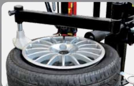
**4 VERSIONE WDK** con il disco al posto del rullo. Insieme all'applicazione della procedura WDK, garantisce operazioni di lavoro omologate. **4 WDK VERSION** with disc instead of roller. Used in conjunction with WDK procedure to ensure compliance with WDK requisites. **4 WDK-AUSFÜHRUNG** mit Scheibe anstelle der Rolle. In Verbindung mit der Anwendung des WDK-Verfahrens gewährleistet sie, dass die Arbeiten den WDK-Vorgaben entsprechen.
