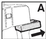
Para levantar el brazo vertical y bloquear el brazo horizontal.
