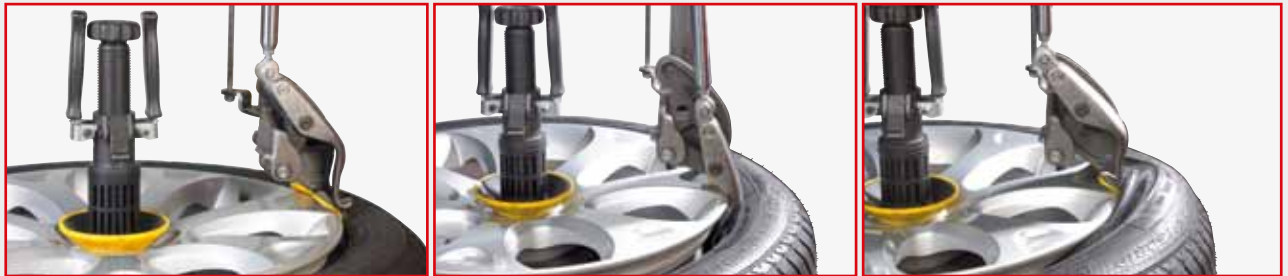
Demontageverfahren des oberen Wulstes
