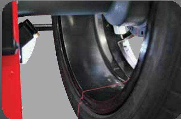
**LASERPOINTER** gestattet eine fehlerfreie und schnellere Positionierung der Gegengewichte. **DIE BELEUCHTUNG** des Radinneren erleichtert den Erwerb von Messungen, das Anbringen der Gegengewichte, die Reinigung und die Kontrolle der Unversehrtheit der Felge.\*
