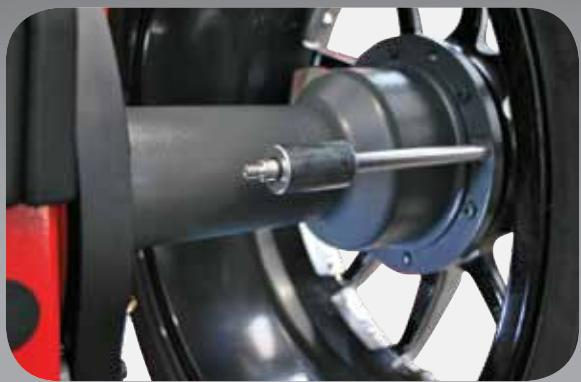
● **ÉTALONNAGE RAPIDE** et intuitif de la sensibilité. La masse étalon, en dotation, s'applique directement sur le groupe de lancement. En configuration moto, les accessoires véhicules ne sont pas requis. ●
