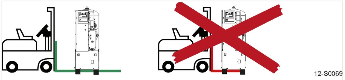
Abb. 37 Mit Gabelstapler transportieren
