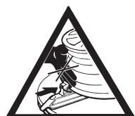
Durante el bloqueo de la llanta en el mandril auto centrante, no introducir nunca las manos entre la cuña de bloqueo y la llanta.
