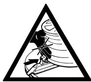
Pendant la phase de blocage de la jante sur le plateau tournant, ne jamais mettre les mains entre le coin et la jante.
