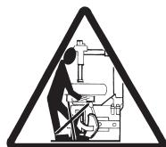
Peligro de aplastamiento. No introducir nunca ninguna parte del cuerpo entre la paleta destalonadora, la llanta y el apoyo de esta última.
