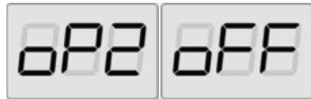
Fig. 31: Desactivación de la memoria del operador 2 - La memoria del operador 1 será recuperada
