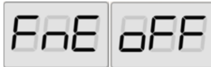
Abb. 29: Sperren der Unwuchtanzeige mit hoher Auflösung
