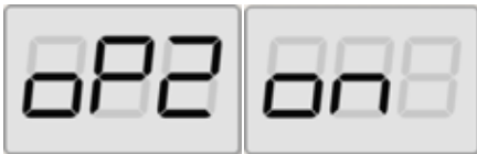
Fig. 30: Activación memoria operador 2 - La memoria del operador 1 es almacenada
