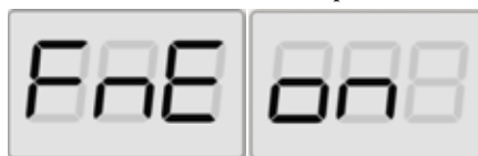
Fig. 28: Activación visualización del desequilibrio en alta resolución
