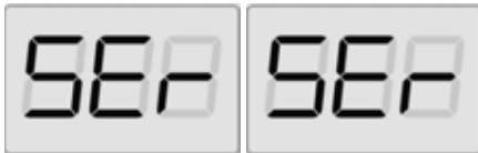
Abb. 32: Modus SERVICE freigeschaltet
