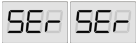
Fig. 32: Modo SERVICE activado
