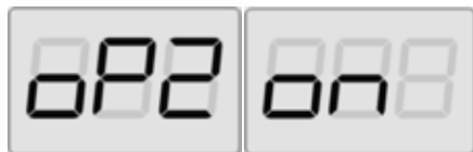
Fig. 30 : Activation de la mémoire opérateur 2 - La mémoire opérateur 1 est sauvegardée
