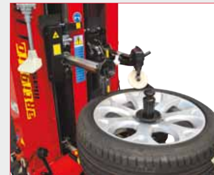
positionnement automatique outils pour cycle manuel
