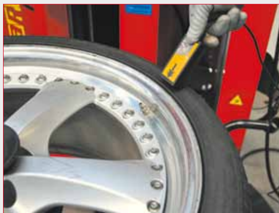
instrument pour intercepter le capteur et ses données
