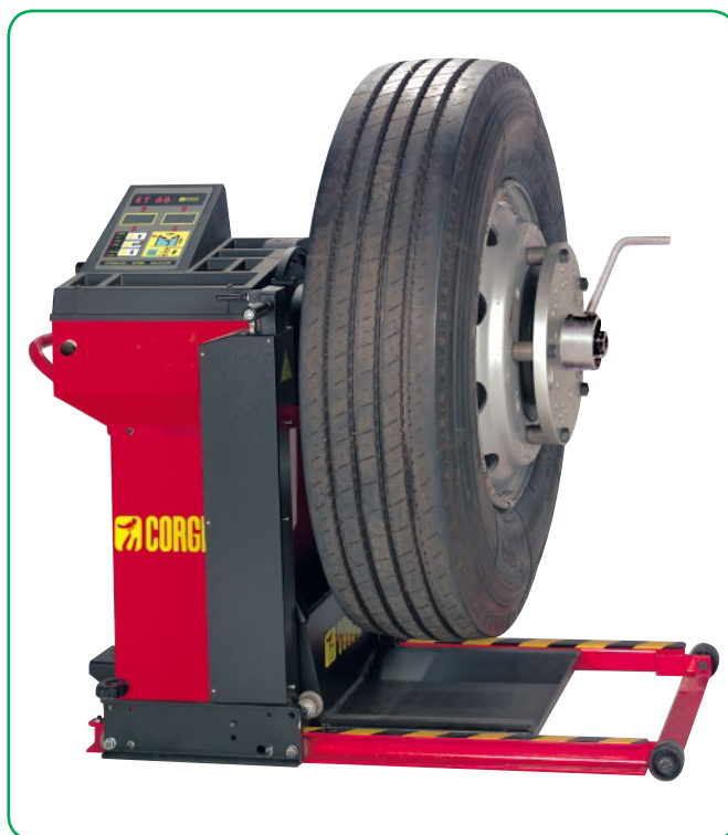
➤ Version avec lancement manuel de la roue (Hand Spin)
