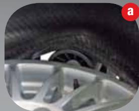
**2 Le GRAND DISQUE** permet de soulever le pneu et de détacher le talon inférieur. **2 El DISCO GRANDE** permite la elevación del neumático y la desconexión del talón inferior. **2 O DISCO GRANDE** permite a elevação do pneu e a separação do talão inferior.
