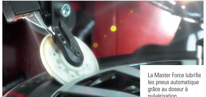
La Master Force lubrifie les pneus automatique grâce au doseur à pulvérisation.
