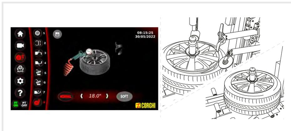
Se in precedenza è stato premuto il tasto PROCEDURA PREPARAZIONE AL GONFIAGGIO durante la FASE 8, la macchina mostrerà la schermata Inflatron (opzionale) così da permettere l'utilizzo dello strumento una volta che viene terminata l'operazione di montaggio.
